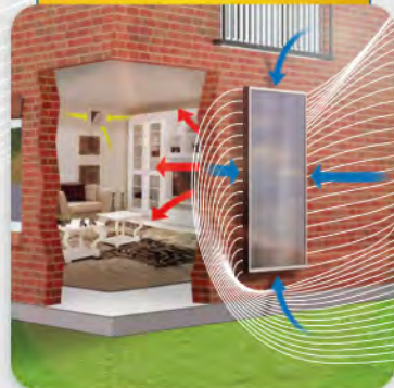
Luftsolfangere til villaer
